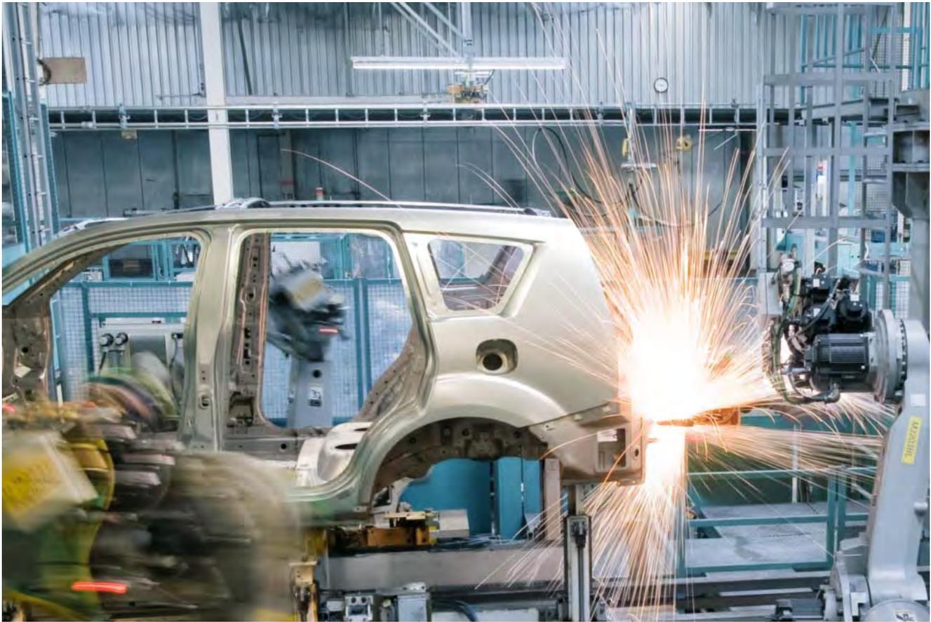
Nella costruzione di carrozzerie vengono assemblati fino a 200 singoli elementi e gruppi costruttivi per formare una carrozzeria autoportante.
