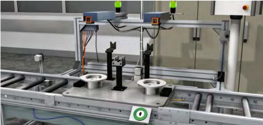
**Controllo della posizione dei dischi del freno**
