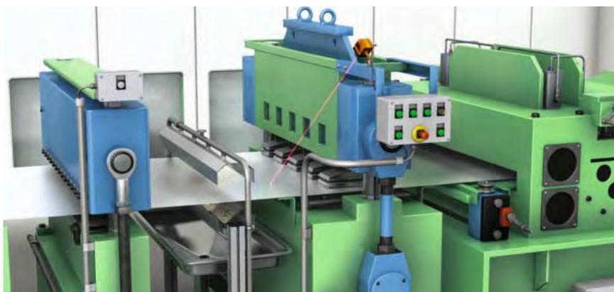
**Sensori analogici di pressione per il controllo dei cilindri di raddrizzamento**
