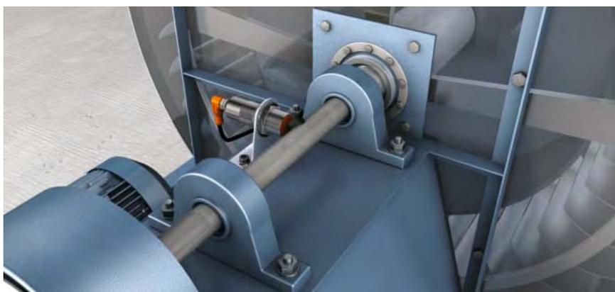
**Rilevamento della velocità di ventilatori**
